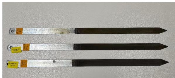
Abb. 18: Grillspiesse nach den Freisetzungsversuchen: das Zink an der Oberfläche ist oxidiert.
