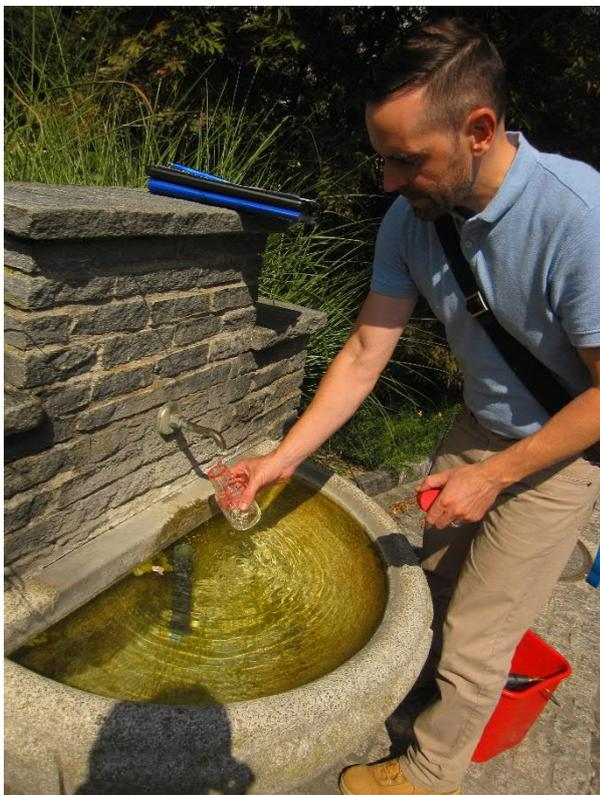
**Abbildung 7:** Auch an öffentlichen Brunnen werden Trinkwasserproben genommen und untersucht.
