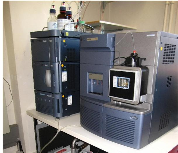
**Abbildung 5:** Das LC-MS/MS-Analysegerät ist ein Präzisionsgerät, das selbst kleinste Konzentrationen, beispielsweise von Pestizidrückständen, nachweisen kann.
