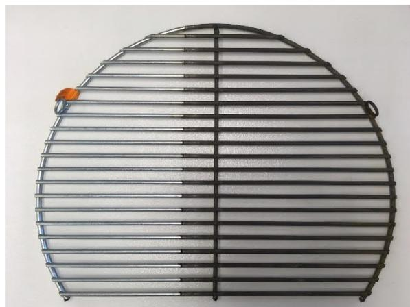
**Abbildung 12:** Dieser verzinnte Grillrost wurde einem Lebensmittelsimulanz ausgesetzt und zeigt deutliche Migrationsspuren.
