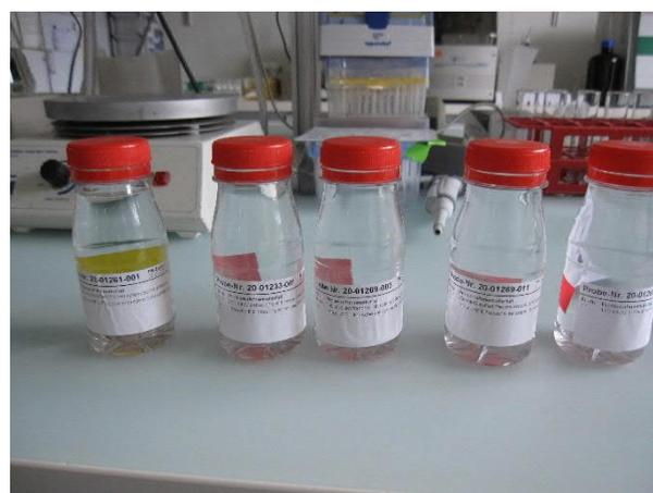
**Abbildung 3:** Wasserproben müssen nach klaren Vorgaben beschriftet sein, damit sie vom kantonalen Labor auch richtig zugeordnet werden können.
