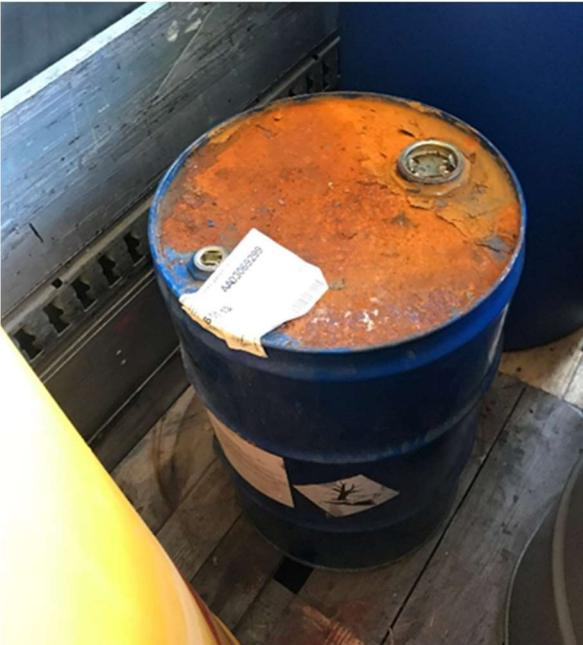
Abbildung 25: Stark korrodiertes Gebinde
