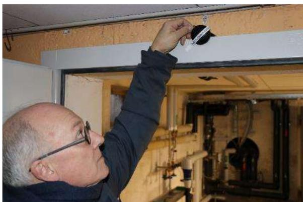
**Abbildung 20:** Im Keller eines Kindergartens wird das Radondosimeter wieder eingesammelt.
