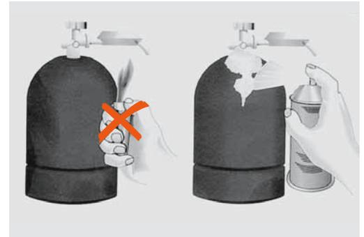
Bild 5: Dichtigkeitsprüfung.
