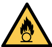
Warnung vor brandfördernden Stoffen
