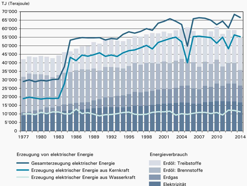
Der Rückgang bei der Gesamtenergieerzeugung sowie der Erzeugung von Energie aus Kernkraft im Jahr 2005 ist auf den Ausfall einer Dampfturbine im Kernkraftwerk Leibstadt zurückzuführen.
