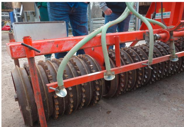
*Für die Frässaat mit schmalen Streifen wird die Säwalze idealerweise mit Prallblechen ausgerüstet, sodass das Saatgut nur in die gefrästen Streifen fällt. (Foto: LZ Liebegg)*
