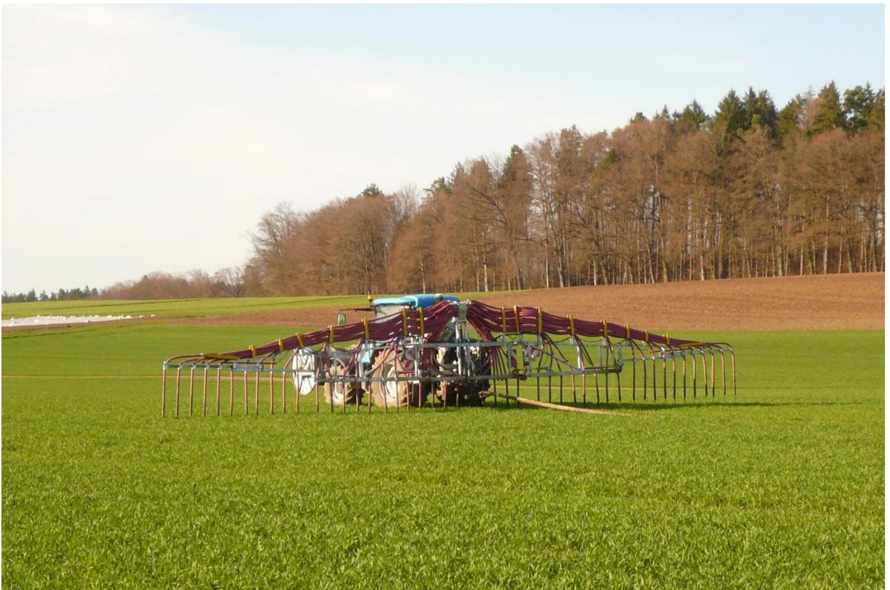
Die Ausbringverfahren Schleppschlauch, Schleppschuh oder Schlitzdrill reduzieren die Ammoniakemissionen markant.
