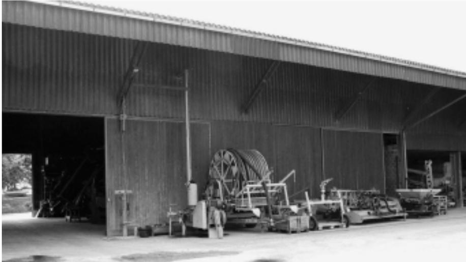
*Abb. 8: Durch ein genügend grosses Vordach kann, vor allem für die kurzfristige Lagerung von Maschinen und Geräten, zusätzlicher Remiseraum geschaffen werden.*
