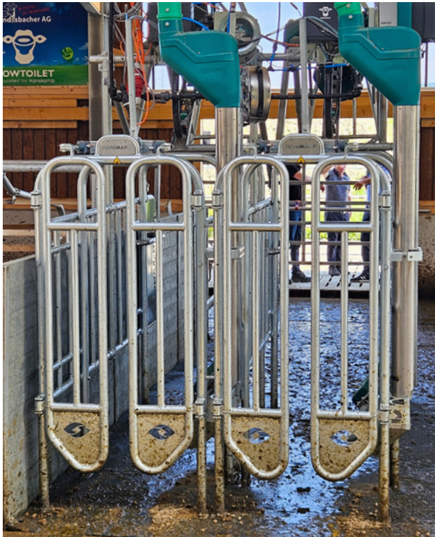
Abbildung 4: Im Rahmen der Umsetzung kann der Bauherr auch auf alternative Massnahmen mit gleicher Wirkung wie die vom Kanton empfohlenen Massnahmen setzen. So ist beispielsweise der Einsatz einer Cowtoilet möglich.
