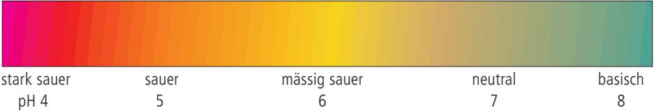
Abb. 3.7: Farbskala und Säuregrad der pH-Indikator-Lösung (Hellige)
