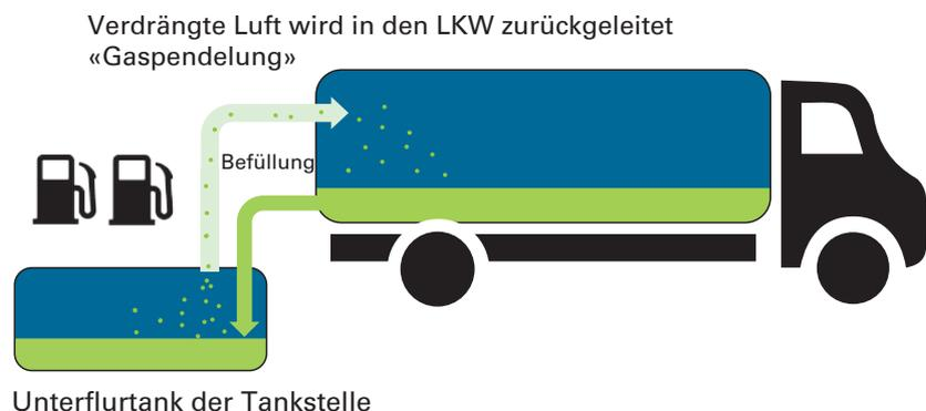
Bei der Gaspendelung wird beim Befüllen von Tanks aus einem LKW die verdrängte benzingesättigte Luft aus dem Tank in den LKW zurückgeleitet. Es handelt sich um einen geschlossenen Kreislauf. So werden Emissionen von flüchtigen organischen Verbindungen beim Benzinablad vermieden.
