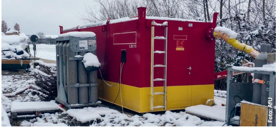
Neutralisationsanlage mit einem Bündel CO<sub>2</sub>-Flaschen: Saure und alkalische Baustellenabwässer müssen nach der Neutralisation einen pH-Wert zwischen 6,5 und 9,0 aufweisen.
