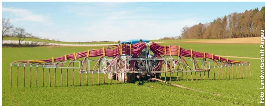
*Einsatz eines Schleppschlauchverteilers auf einer Parzelle mit Winterweizen für die Düngung mit Gülle im Frühling anstelle von Mineraldünger*
