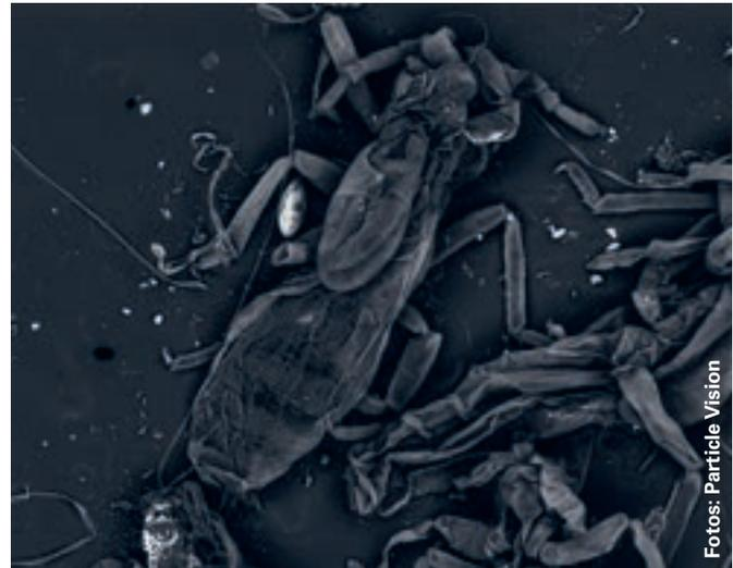
Dank der Vergrößerung im Rasterelektronenmikroskop (rechts) konnte der weisse Niederschlag als Insektenhäute identifiziert werden.
