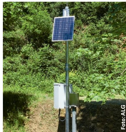
Umrüstung B-Netz+: Die kleineren Messstationen werden neu mit Solarenergie betrieben (Erzbach in Erlinsbach).
