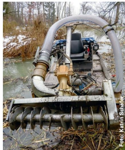
*Pumpeinheit des amphibischen Saugbaggers: Zu sehen sind die «Schnecke», die den Boden aufräst bzw. aufwühlt, und ein Teil des Druckrohrs, mit dem das Schlamm-Wasser-Gemisch an Land gepumpt wird.*
