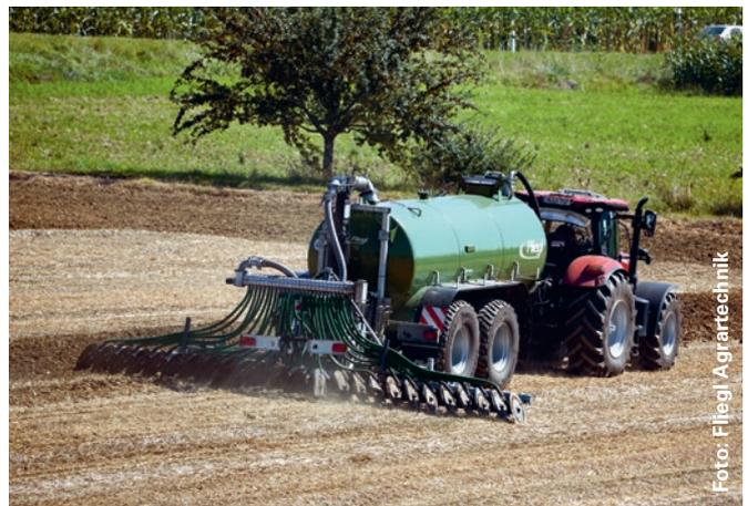
Emissionsarme Ausbringtechnik von Gülle mit dem Schleppschlauch
