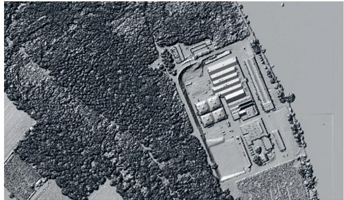
Aus LiDAR-Daten können verschiedene Rastermodelle abgeleitet werden. Links: digitales Geländemodell DTM (Hillshade) mit erkennbaren Waldstrassen und Rückegassen. Rechts: digitales Oberflächenmodell DOM (Hillshade) mit Wald, Feldern und Gebäuden
