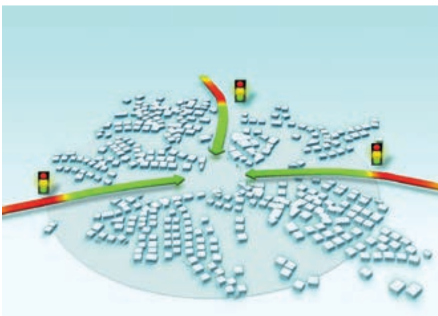
Lichtsignalanlagen an der Peripherie verhindern, dass sich die Autokolonnen im Zentrum oder in dicht besiedeltem Gebiet stauen. Quelle: Kanton Aargau
