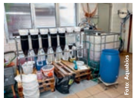
Schematische Darstellung der Markierungsanlage (links) und die umgesetzte Anlage in der Brutanlage «Delphin» (rechts). Die Felcheneier werden zur Markierung für eine bestimmte Zeit in einem Wasserbad dem Fluoreszenzfarbstoff Alizarinrot S ausgesetzt.
