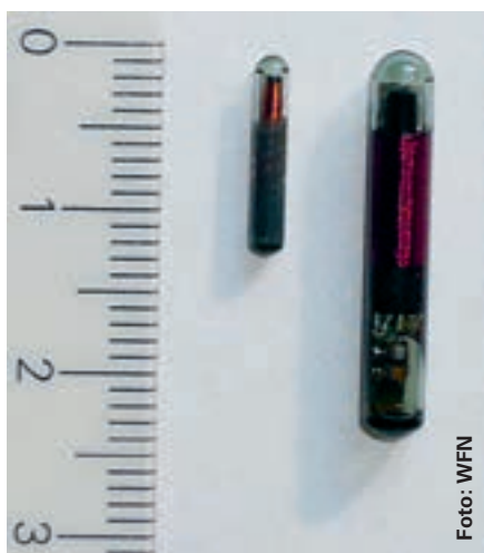
PIT-Tags in den zwei verwendeten Grössen: 12 mm für kleine Fische, 24 mm für grössere
