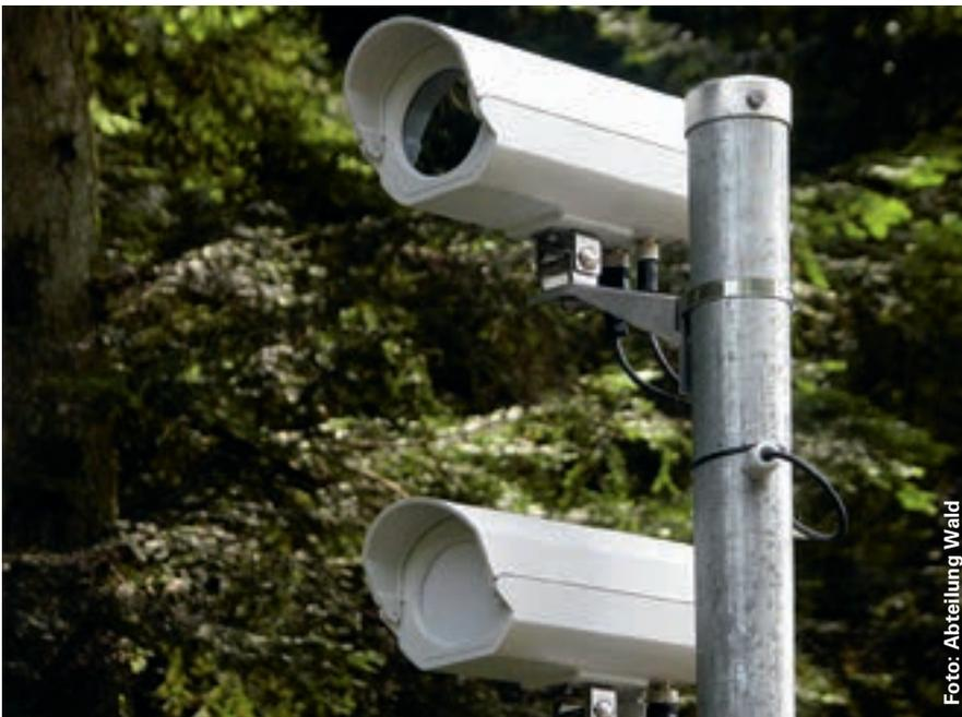
*Hier wird keine Geschwindigkeitskontrolle gemacht. Sondern hochentwickelte Infrarotsensoren tasten den Strassenrand ab und erkennen sich bewegende Wärmequellen wie Wildtiere.*
