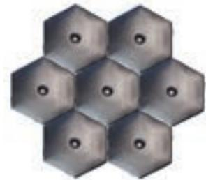
Matrix Cover® sind sechseckige, hohle Kunststoffelemente aus Polyethylen (HDPE). Sie haben einen Durchmesser von 46,2 Zentimeter und eine Höhe von 9 Zentimeter. Die Kunststoffelemente werden auf die flüssige Gülle geschüttet und organisieren sich selber zu einem Verbund, ähnlich der Struktur bei Bienenwaben. Die Kunststoffelemente brauchen eine flüssige Gülle, um sich organisieren zu können, bei Gülle mit Schwimmedecke oder ähnlichen zähen, festen Oberflächen eignen sie sich nicht als Abdeckung.
