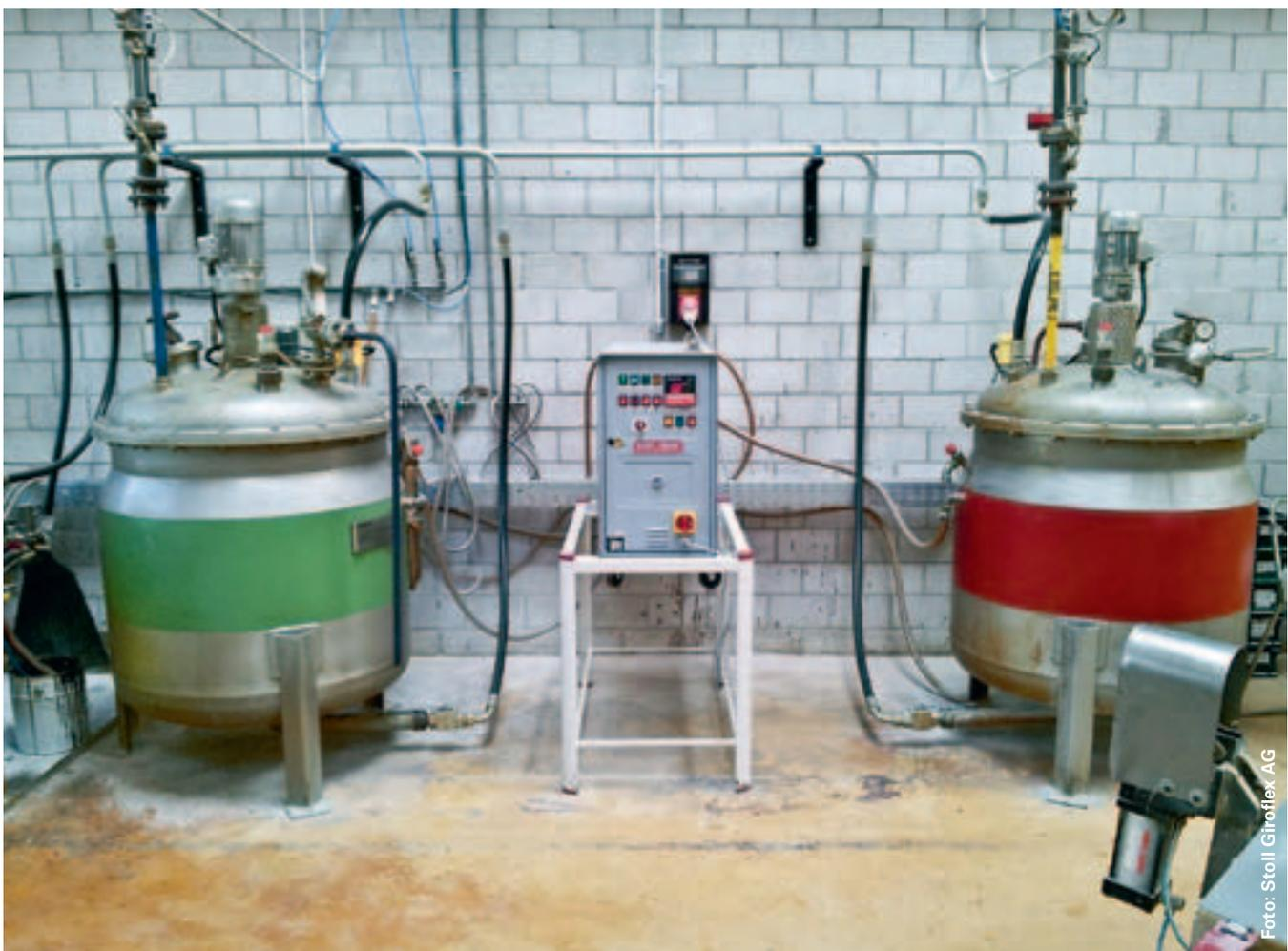
*Zwischen den zwei Rohstoffbehälter für die Schaumstoffproduktionist das neue Kühlgerät zu sehen.*
