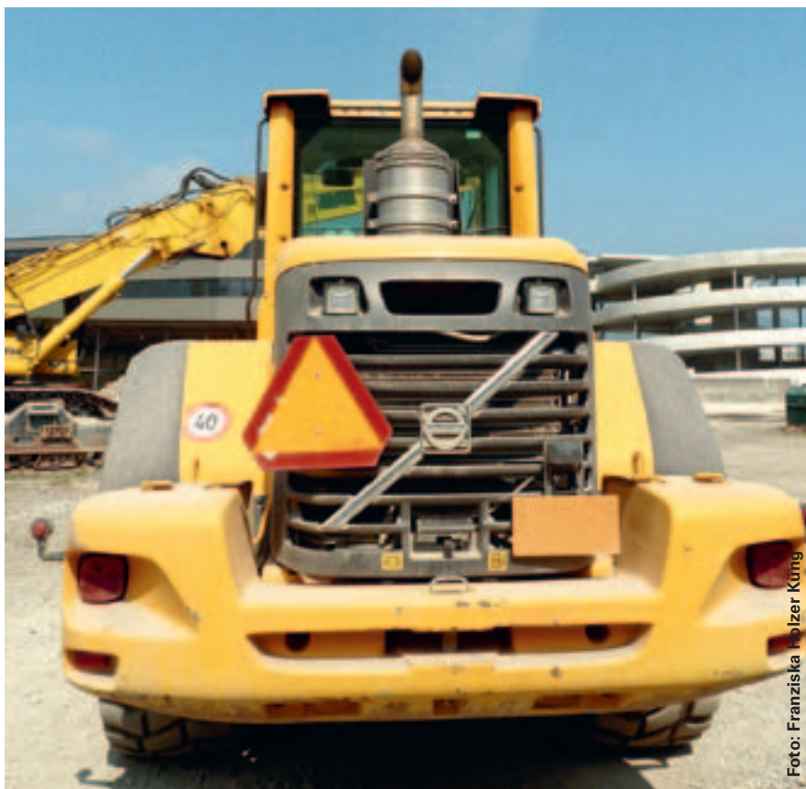
Pneulader mit markantem, nachträglich aufgebautem Partikelfilter.
