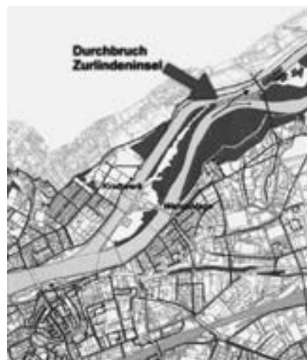
*Nach dem Durchbruch der Zurlindeninsel entstand ein Rückstau bis zum Kraftwerk, was zu dessen Totalausfall führte, zudem drohte der Abwasser-Dücker zu bersten.*
