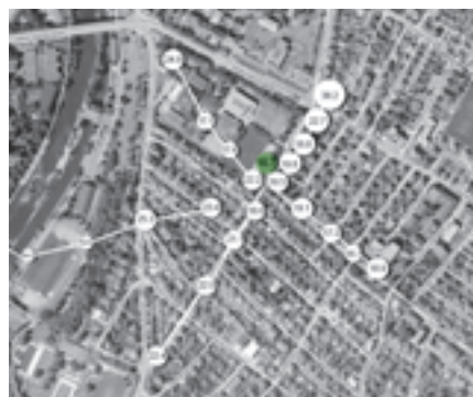
Messstandorte: Tunnel zur Bruggerstrasse (links), sternförmige Messreihe von der Kantonsschule Baden aus (Mitte) und Messkreise um den Schulhausplatz (rechts). Die Zahlen geben die Stickstoffdioxid-Konzentrationen in Mikrogramm pro Kubikmeter an.
