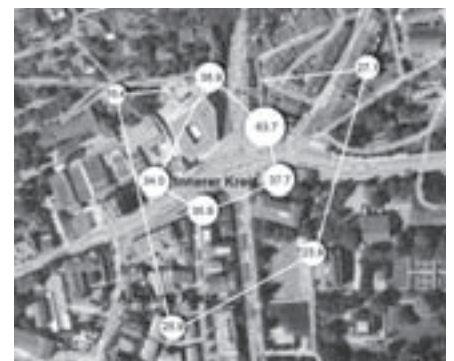
Messstandorte: Tunnel zur Bruggerstrasse (links), sternförmige Messreihe von der Kantonsschule Baden aus (Mitte) und Messkreise um den Schulhausplatz (rechts). Die Zahlen geben die Stickstoffdioxid-Konzentrationen in Mikrogramm pro Kubikmeter an.
