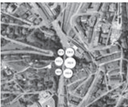
Messstandorte: Tunnel zur Bruggerstrasse (links), sternförmige Messreihe von der Kantonsschule Baden aus (Mitte) und Messkreise um den Schulhausplatz (rechts). Die Zahlen geben die Stickstoffdioxid-Konzentrationen in Mikrogramm pro Kubikmeter an.
