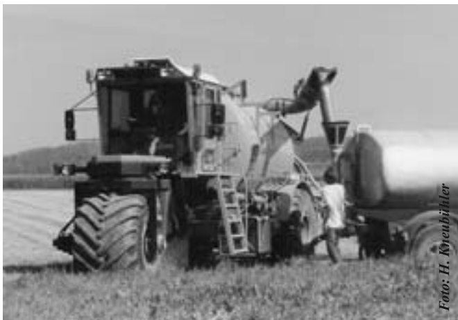
Dreirädriges Spezialfahrzeug zum direkten Einarbeiten von Klärschlamm beim Umpumpen ab dem Tankwagen
