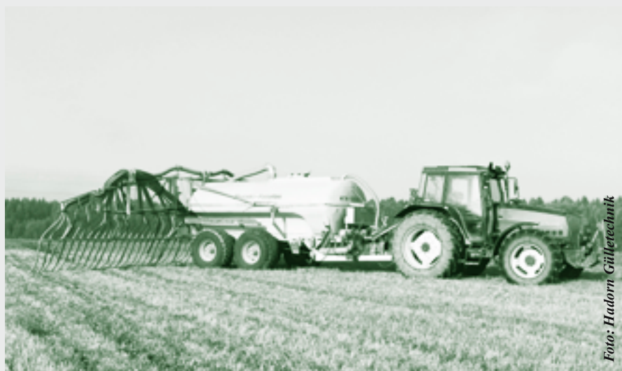
Güllen mit Schleppschlauch; so werden weniger Vorläufersubstanzen für Sekundärpartikel freigesetzt.
