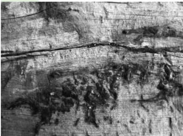
*Das schadstoffreiche Teeröl tritt bei höheren Temperaturen oder bei Hangwasserdruck an die Oberfläche.*
