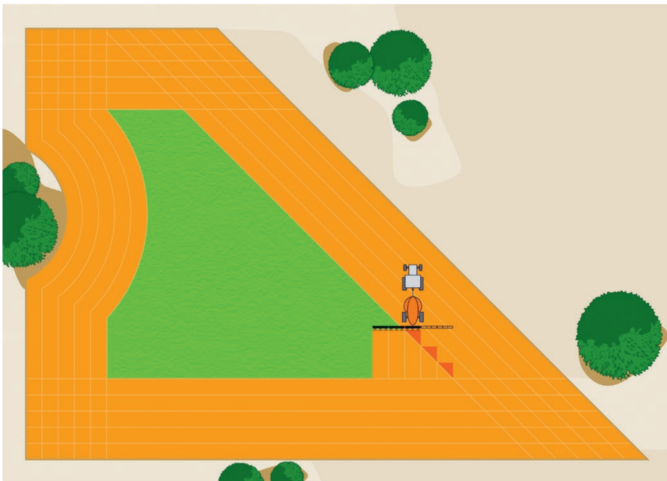
Mit einer GPS-gesteuerten Feldspritze kann exakt bestimmt werden, wo gespritzt werden soll. Quelle: Amazonen-Werke
