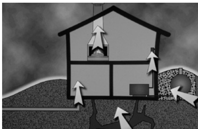
Abbildung 2: Durch den Kamineffekt gelangt vor allem während der kalten Jahreszeit Radon aus dem Bauuntergrund ins Hausinnere.
