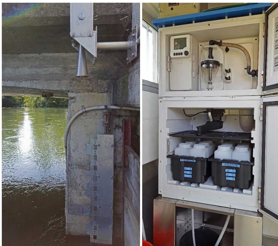
Abbildung 8: Hydrometrische Mess- und Probenahmestation Frauental an der Lorze. Foto links: Pegelmessung mit Radar und Ansaugschlauch des Wasserprobennehmers. Foto rechts: Dosiereinheit für Wasserproben integriert in Kühlschrank. Quelle Fotos: AFU Zug
