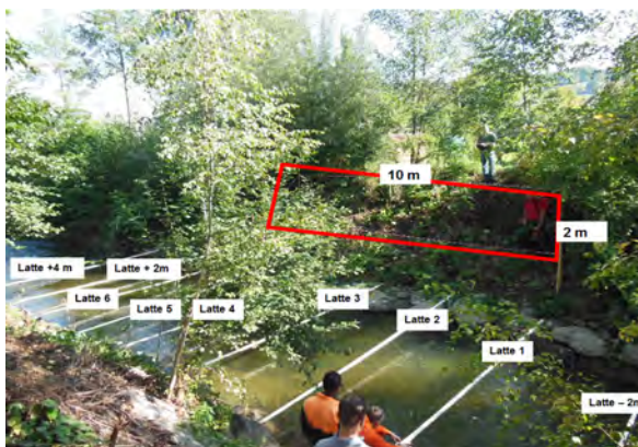
Abb. 4: Anordnung der Filterpapierstreifen, die den Tracer auffangen, auf Dachlatten, die über dem Bach ausgelegt werden.
