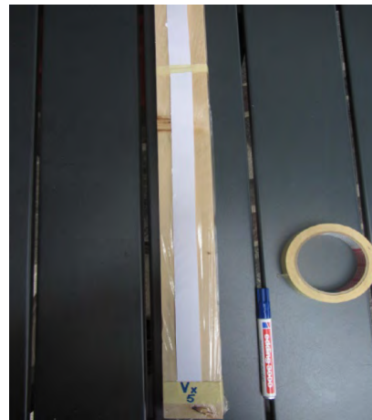
Festkleben der beiden Enden und Beschriften mit Versuchs- und Lattennummer
