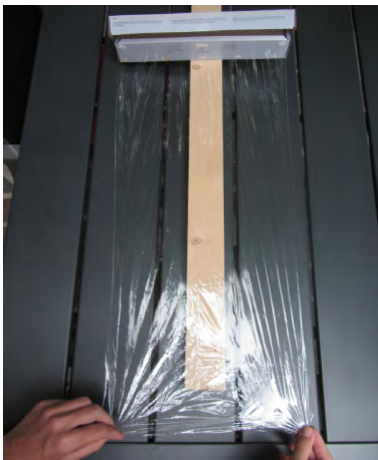
Überziehen der Dachlatten mit Frischhaltefolie
