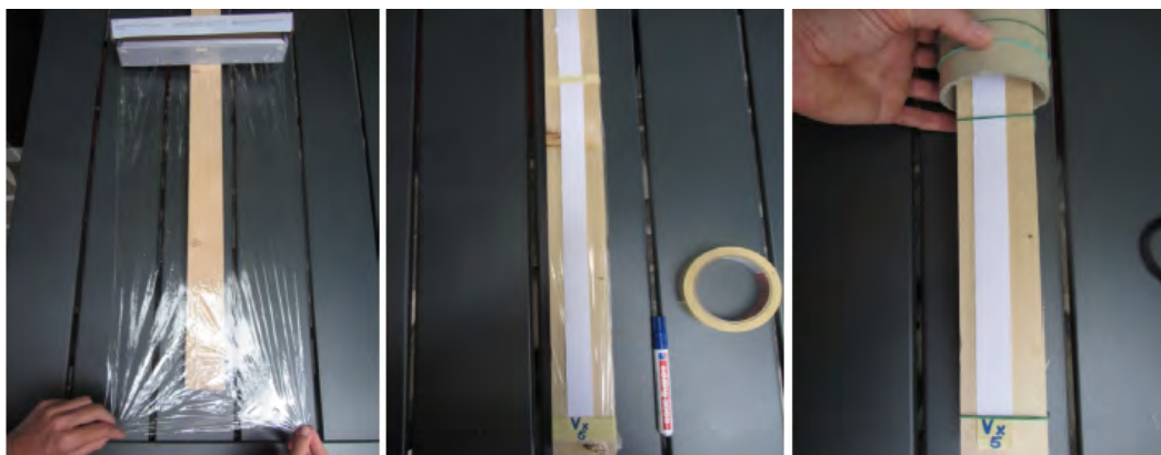
Abb. 7: Vorbereiten der Dachlatten mit Filterpapierstreifen: 1. Überziehen der Dachlatten mit Frischhaltefolie; 2. Festkleben der beiden Enden und Beschriften mit Versuchs- und Lattennummer; 3. Fixieren der Filterpapierstreifen mit Gummiringen. Das ausgeklügelte Vorgehen war nötig, um eine Kontamination der frischen Filterpapierstreifen mit Tracer aus vorangehenden Spritzdurchgängen sicher ausschliessen zu können.
