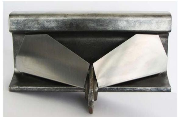
Modell: Gleisabweiser an ein Gleis-Stück montiert
