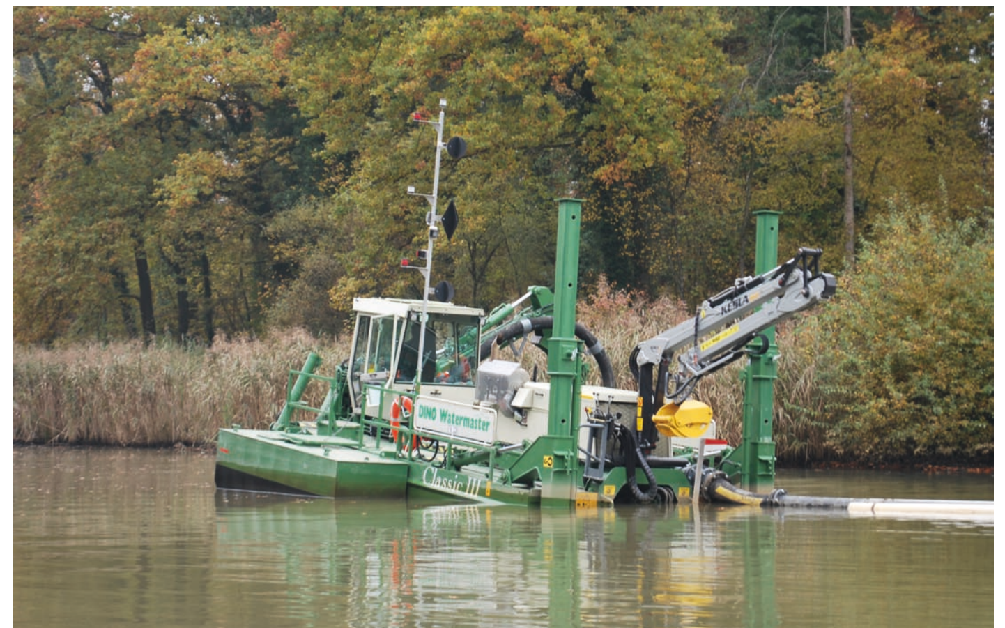
Rund 17 Tonnen wiegt der gut 10 Meter lange Saugbagger, der schwimmen, aber auch «gehen» kann.
