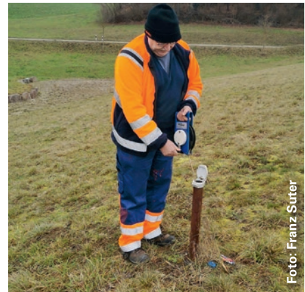
Mit dem Piezometer misst der Talsperrenwärter die Höhenlage des Bodenwassers im Dammkörper.
