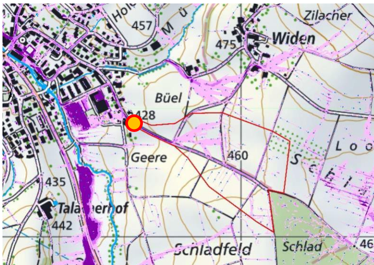
Abbildung 4: Massgebendes Einzugsgebiet für den roten BP «Zürichstrasse» [2]
