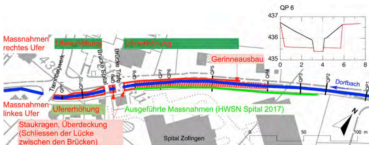
Bild 5 Situation Variante OFDB2c: In roter Schrift sind die geplanten Massnahmen und in grüner Schrift die für den Hochwasserschutz des Spitals bereits ausgeführten Massnahmen dargestellt. Oben rechts ist zudem exemplarisch für Querprofil 6 der Ausbau des Gerinnes eingezeichnet.
