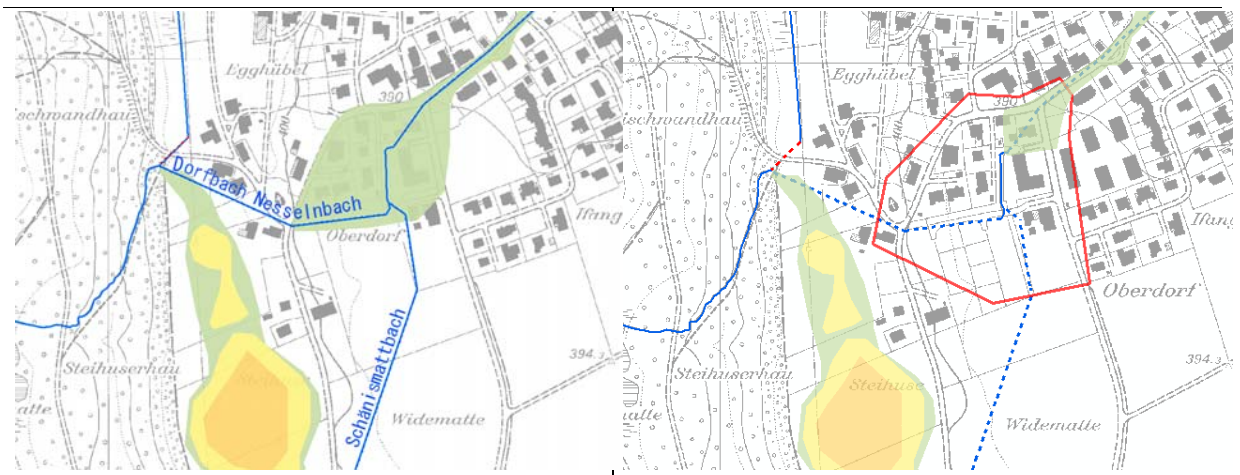
Abbildung 12 Fliesstiefenkarte 300-jähriges Hochwasser vor und nach Massnahmen
