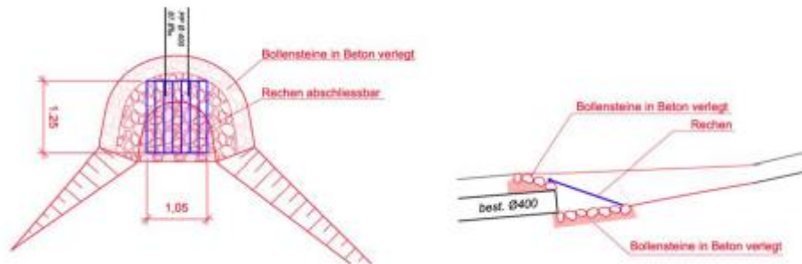
Abbildung 5 Massnahmen-skizzen Bereich Eindolung Reichstrasse, Grundriss und Schnitt
