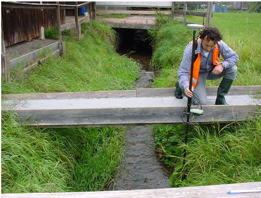
Abb. 4: Querprofilaufnahme mit GPS am Hünikerbach Schneisingen
