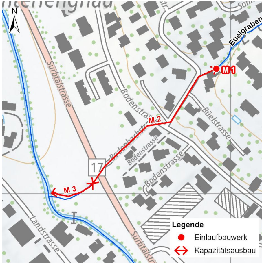
Abbildung 3: Umgesetzte Hochwasserschutzmassnahmen Euelgraben. Legende: M x = Massnahme x
