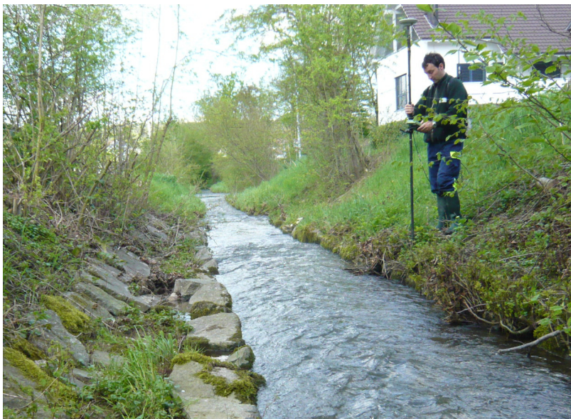
Abb. 4: Querprofilaufnahme mit GPS am Fisibach
