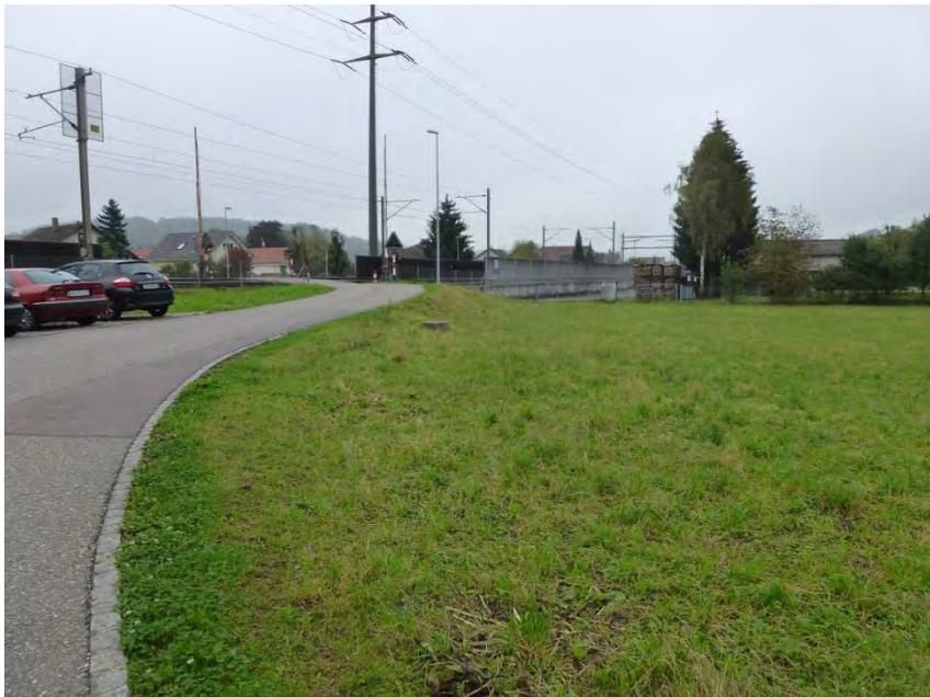
Auf Höhe des Gemeindehauses ist die Lärmschutzwand unterbrochen. In diesem Bereich kann bei grossem Aufstau Wasser weiterhin über das Bahngeleise fließen.
