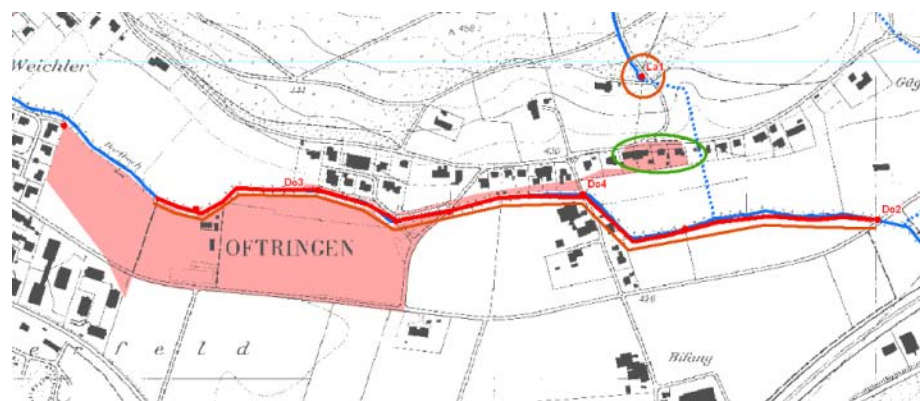
Abb. 23 Der Dorfbach von der A1 bis zum Sportplatz. Brücken und ein ungenügender Gerinnequerschnitt verursachen das Schutzdefizit.
