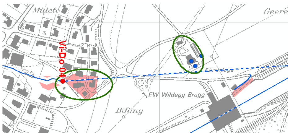
Abb. 81 Als sinnvollste Massnahme um das Schutzdefizit von Vi-Do 04 zu verringern wird der Objektschutz an den betroffenen Gebäuden erachtet.
