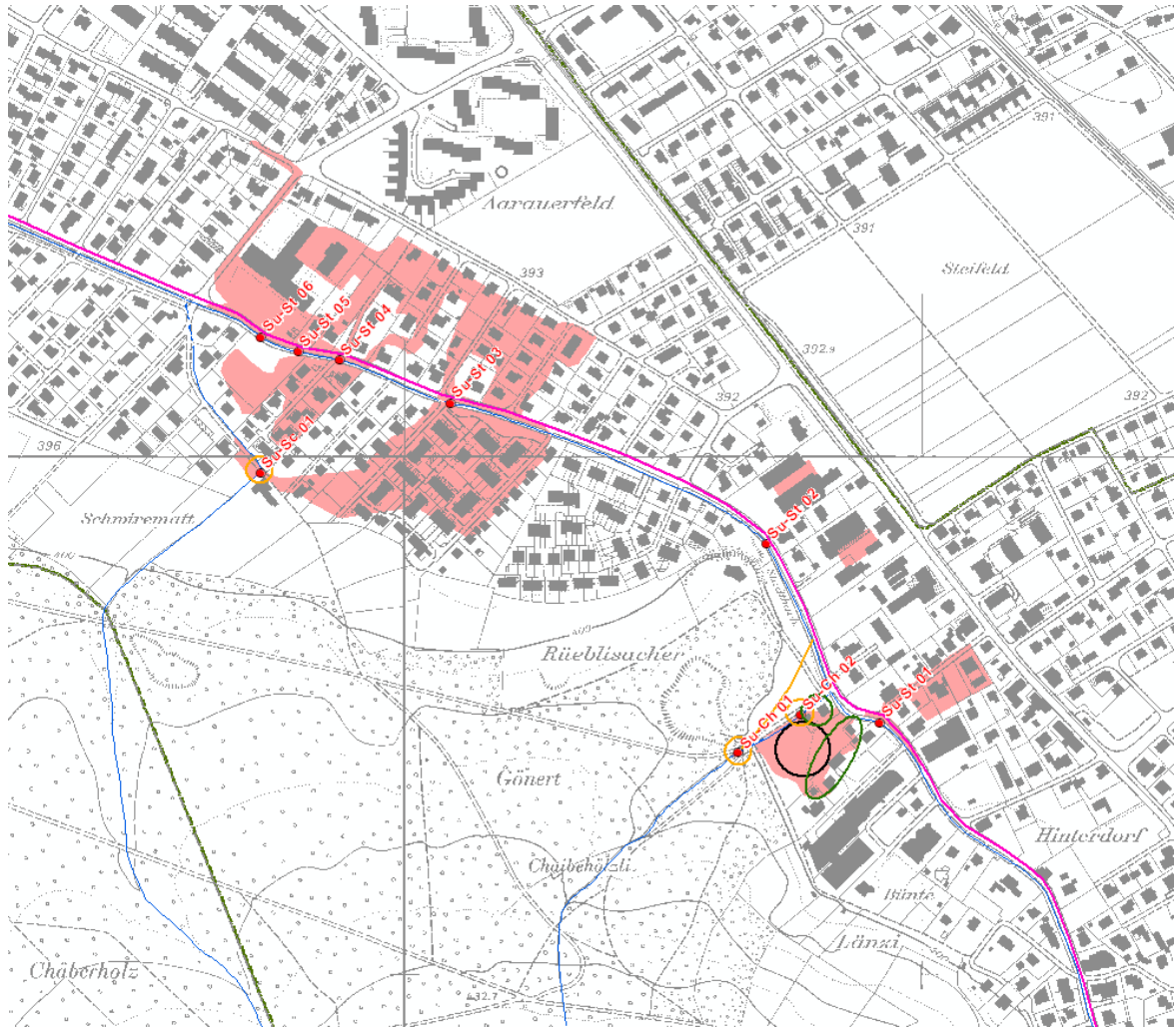
Abb. 68 Eine gesteuerte Einlaufdrossel verringert im Bereich der Gemeinde Suhr die Hochwassergefährdung. Zudem ist permanenter Unterhalt erforderlich.
