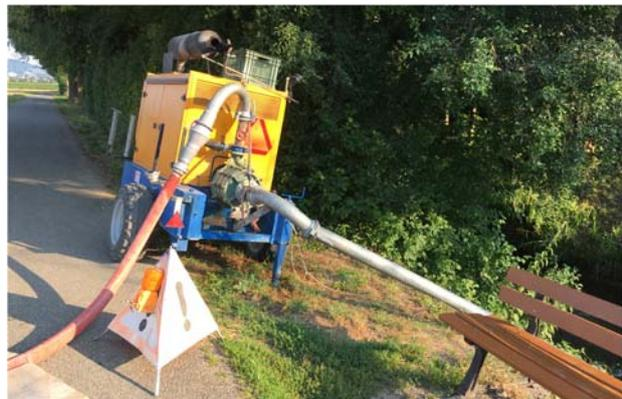
Pumpe zur Wasserentnahme aus Fließgewässern, vor der Siftung der Bewilligungen (Bild ALG)
