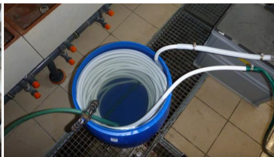
Abbildung 4-2. Links: Pumpen, die für den Wasserdurchfluss im Einsatz waren; Rechts: Der Farbstoff durchfließt das Kühlbecken in drei Kühlschlaufen, bevor die Eier mit der Lösung durchflossen werden.
