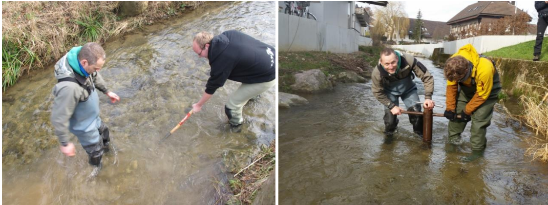
Abbildung 3-4. Links: Graben einer künstlichen Laichgrube; Rechts: Positionierung des Injektors in die Laichgrube.
