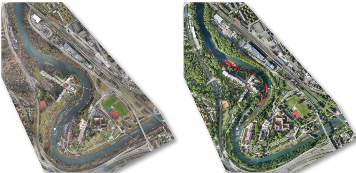
**Abbildung 12:** Mittels Drohnenflügen aufgenommene Luftbilder bei hohem (links) und tiefem (rechts) Wasserstand in der Limmatschleife und Webermühle (Teilgebiet 1). Die potenziell trockenfallenden Flächen sind rot umrandet.
