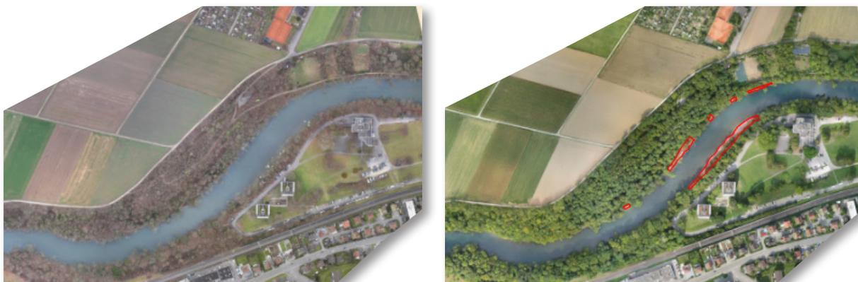
**Abbildung 14:** Mittels Drohnenflügen aufgenommene Luftbilder bei hohem (links) und tiefem (rechts) Wasserstand im Gebiet Hard / Brisgi (Teilgebiet 3 oben). Die potenziell trockenfallenden Flächen sind rot umrandet.
