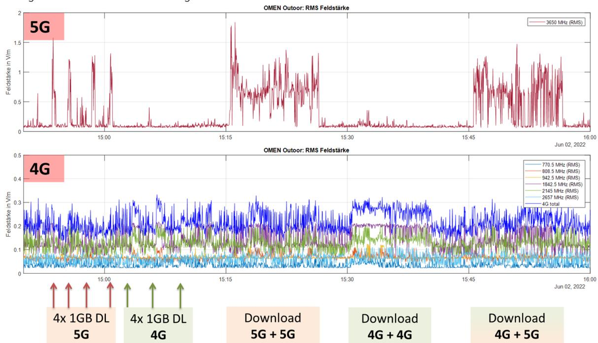
Abbildung 48: Feldstärkeverlauf im 5G Band (obere Grafik) und 4G Bänder (unten) am Standort 'OMEN'-Aussen während den Traffic-Tests am Standort 'OMEN'. Abgebildet sind die vom ExpoM-RF gemessenen Effektivwerte (ohne zeitliche Mittelung)
