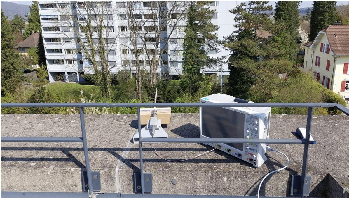
Abbildung 3: Messaufbau Vergleichsmessung mit Oszilloskop auf der Dachterrasse des Gebäudes der Verwaltung des Kt. Aargau. Rechts neben dem Oszilloskop ist das ExpoM-RF Gerät zu sehen.
