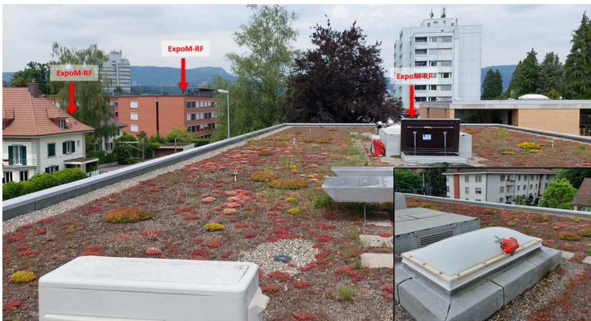
Abbildung 5: Traffic-Tests: Standorte der Messgeräte (Sicht vom Dach von G+P) mit Detailansicht der Installation des Messkoffers
